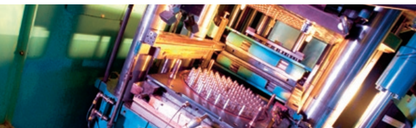
Vulkanisationspresse für hochpräzise Sicherheitsteile im Automobil.
