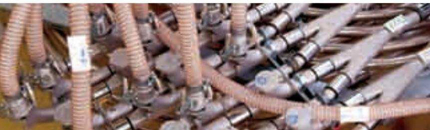
Granulat-Zuführsystem in der Fertigung von pharmazeutischen Verschlüssen.
