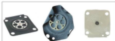
Bild 1: Im Vergleich: Originalmembran (links), benutzergealterte Membran (Mitte) und PEEK-Membran (rechts)
