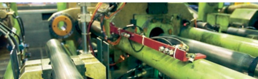
Weiterbearbeitung von Präzisionsrohren zu Gelenkwellenrohren für die Fahrzeugindustrie.
