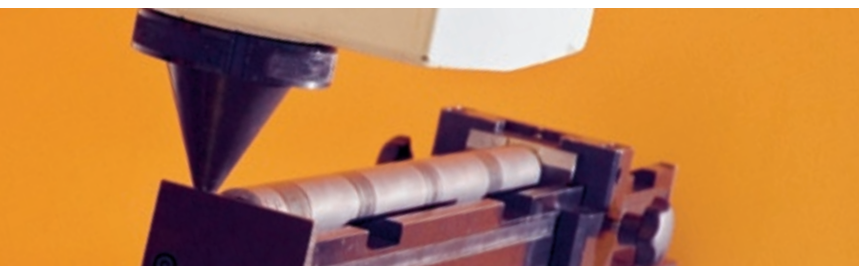
Nockenwellenrohre von Rothrist ersetzen im Automobilbau das Vollmaterial.
