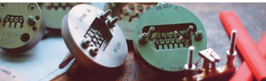
Extrusionswerkzeuge zur Herstellung von Gummidichtungen für den Tunnelbau.
