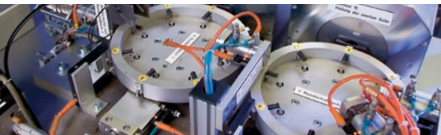
Vollautomatische Qualitätskontrolle von Sicherheitsteilen für die Autoindustrie.
